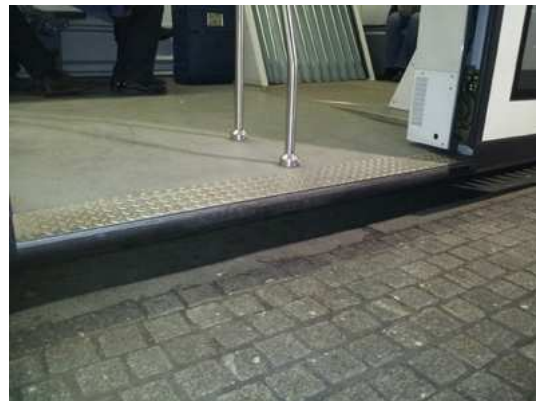
Abb. 10 Hochflurbahnsteig „Silberpfeil“ Einstiegsschwelle 5 cm, Foto: D.Gardemin
